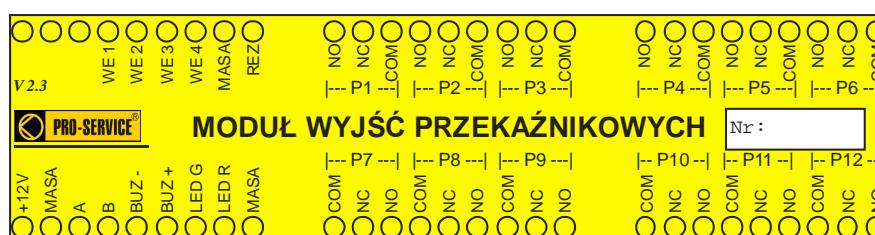
Rys. 6. – Płyta czołowa modułu wyjść przekaźnikowych centrali modularPAG®.
