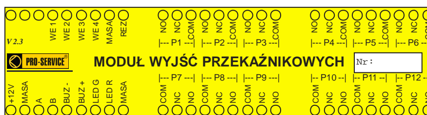
Rys. 6. – Płyta czołowa modułu wyjść przekaźnikowych centrali modularPAG®.
